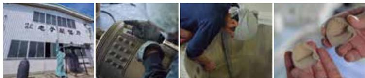
で整えている様子に匠の技を感じる。「鋳物は砂型にお湯(溶かした金属)を入れて固めます。普段の厚さとは違い、蒸留酒向けには肉厚にしなければいけない。また、食品関係の法律を調べたりするなど、意識改革が必要でした」と話す。食品安全上、鉛を使わず、銅錫合金を使用した。「錫は酒の味をまろやかにし、青銅は熱を逃がしにくいため省エネにもなる。砂型を使うと表面に凹凸ができてしまうけれど、蒸気の接触面積が大きくなるため香り高い酒ができる。鋳物の欠点か、長所が変わった」。高山の酒造店に出荷予定という第2号「ZEMON」の横で嬉しそうに笑った。
