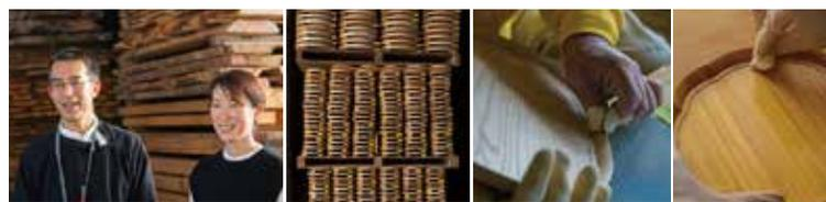
新商品も加わり、洗練された暮らし品として人気ブランドに成長した。工場では、機械で木材を削り出し加工した後、指先ほどの小さな<sup>かんな</sup>鉋やヤスリなどを巧みに使い職人が精緻に手を加えていく。最後に液体ガラス塗装を施せば完成だ。「機械と手しごとを組み合わせたものづくりができるのはわたしたちの強み。無垢の木がもつ心地よさ、美しさを引き出していきたい」。目の前に置かれたKITOの器にそっと触れてみた。ほっとする安らぎと温もりに「木が大好き」という2人の想いが伝わってきた。
