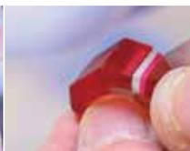
「アクセサリ―の企画デザイン、切削加工・研磨工程は社内で行いますが、その他の加工は近隣のメガネ工場に依頼しています。眼鏡づくりに携わる職人の技を守り、切磋琢磨できれば」と話す。社内の作業場では、職人が高速回転する研磨機を使った指輪をつくっていた。継ぎ目のないリングに磨きを施すと表面に光沢が生まれ、セルロースアセテート独特のしっとりした絹のような光沢を放ち始めた。
